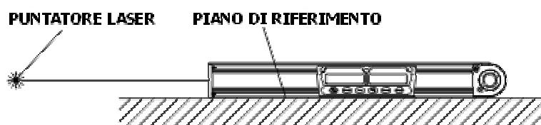
Per misurare l'inclinazione di un piano, accendere la livella e posizionarla sul piano in esame. E' possibile leggere l'inclinazione in gradi o in percentuale, premendo il tasto  $^{\circ}/\%$ .
