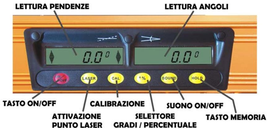
La tastiera dello strumento è composta da 6 tasti: "power" , "laser", "cal", "angle/grade", "sound", "hold".
