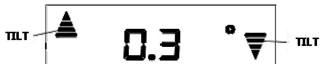
Al raggiungimento del livello, gli indicatori TILT si accendono simultaneamente e, se attivato, un segnale sonoro viene emesso dallo strumento.
